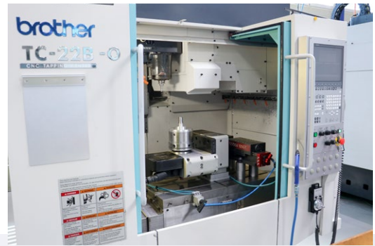
适用于合同制造商的理想生产解决方案：Werder 为 20 台 Brother 机床的其中许多机床都加装了 pL LEHMANN 的两轴分度头，使机床具备了五轴加工的能力。
