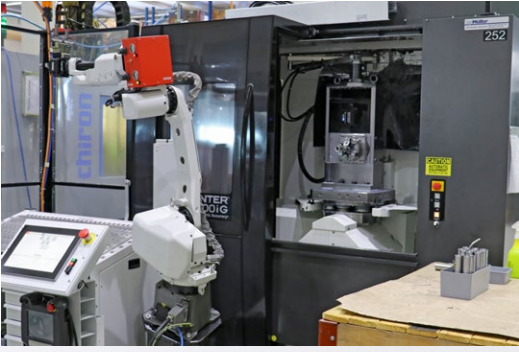
凭借交替式上料台和机器人自动化系统，Kitamura / pL LEHMANN 系统是实现超级经济化 24/7 全天候作业的理想选择。
