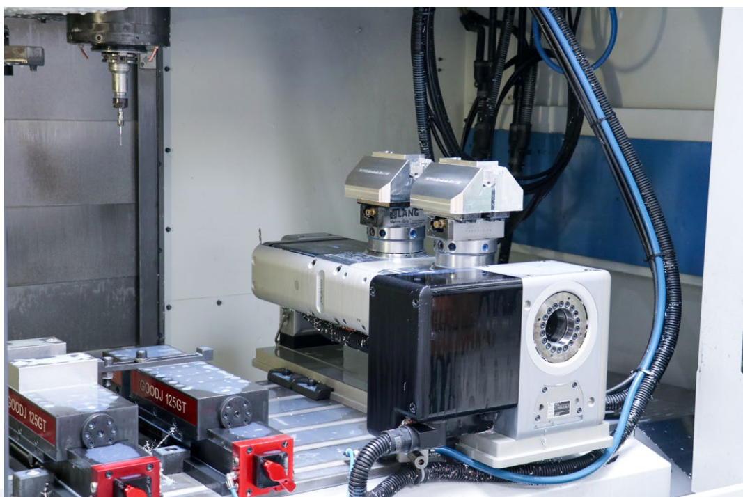
3+2 轴解决方案的好处除了分度头以外，还为背面加工提供了安放一个或两个台钳的空间。
